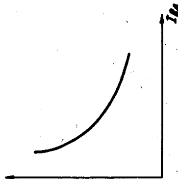
Рис. 5.2. Характеристика холостого хода двигателя для постоянного тока
